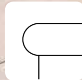
Terminale con lato stondato. Coping with rounded edge. Terminal à bord arrondi. Endstein mit runder Seite.
